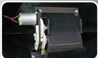
ОПТИМИЗИРОВАННАЯ СИСТЕМА ПОДАЧИ МОНЕТ НА СОРТИРОВОЧНЫЙ ДИСК
