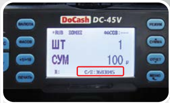
СКАНИРОВАНИЕ И РАСПОЗНАВАНИЕ СЕРИЙНЫХ НОМЕРОВ
