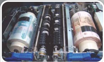
КАССЕТЫ БАРАБАННОГО ТИПА С НАМОТКОЙ ПО КОРОТКОЙ СТОРОНЕ
