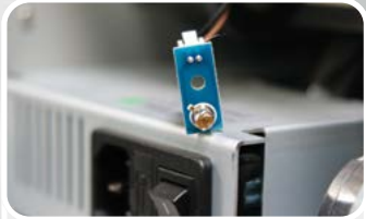
ВЫСОКОЧУВСТВИТЕЛЬНЫЕ ДАТЧИКИ СДВОЕННОСТИ
